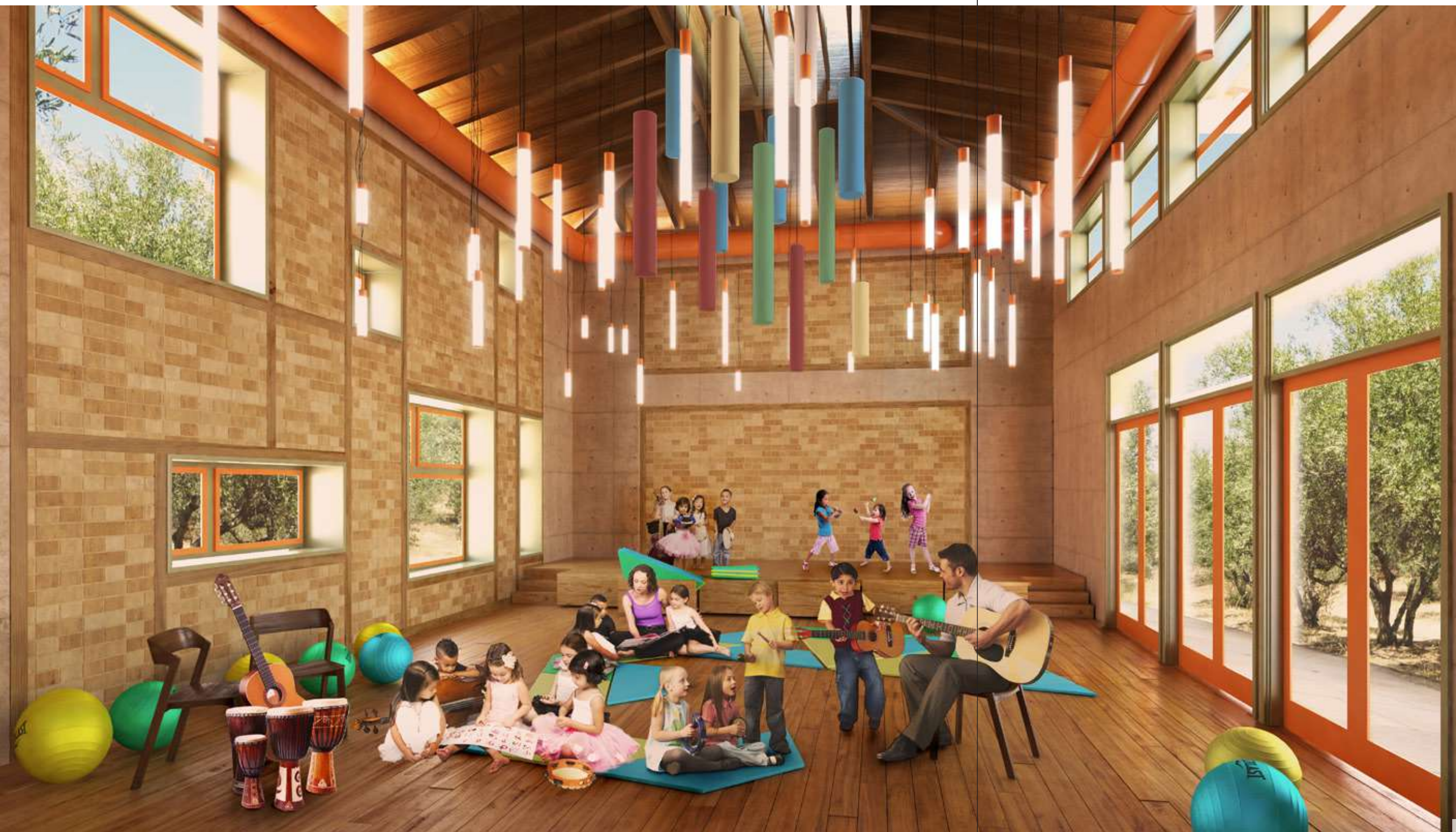
Εικόνα 4: Θερμοχωρητικά υλικά στον χώρο Πολλαπλών Χρήσεων του Νηπιαγωγείου και ηχοαπορροφητές στην οροφή
